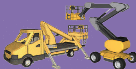
PEMP de type 1 ou 3. élévation multidirectionnelle, déport possible
