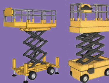
PEMP de type 1 ou 3. élévation verticale
